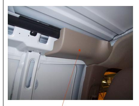
REMOVE OEM PLASTIC COVER ON DRIVER SIDE BY SIMPLY PULLING IT DOWNWARD.
